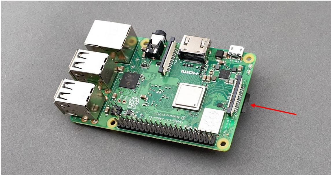
FIGURE 28 MAKE SURE THE MICRO-SD CARD IS SLIDE ALL THE WAY INTO THE RASPBERRY PI
