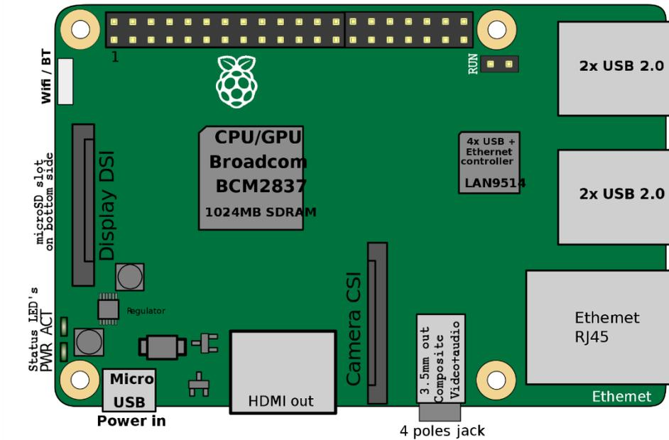
FIGURE 5 RASPBERRY PI 3 MODEL B+ SCHEMATIC
