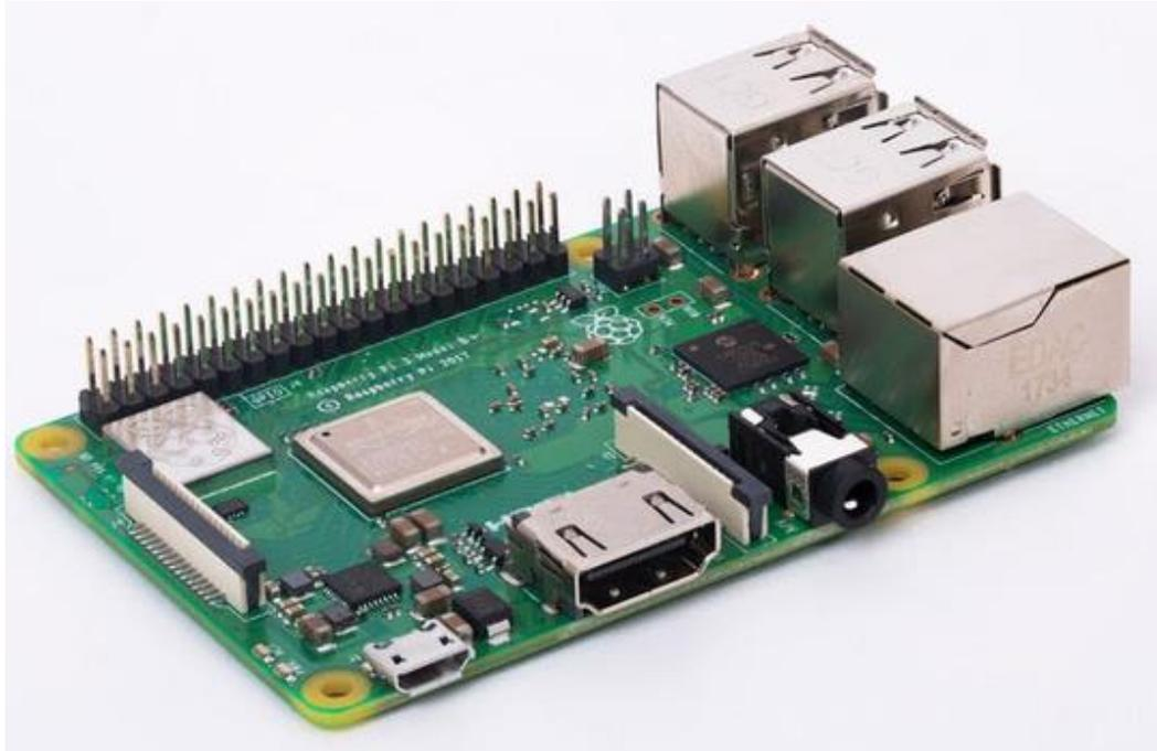
**FIGURE 4 RASPBERRY PI 3 MODEL B+**
