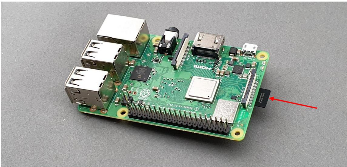
FIGURE 27 INSERT THE MICRO-SD CARD BY SLIDING IT UPSIDE DOWN INTO THE RASPBERRY PI
