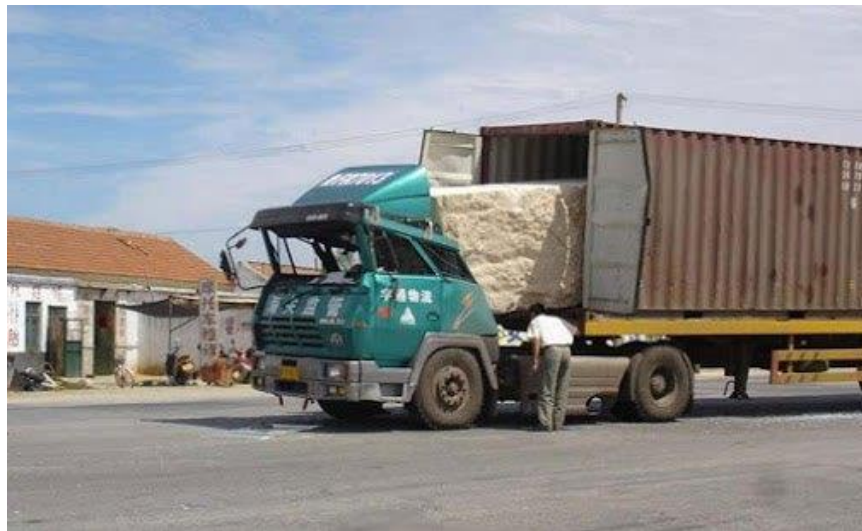
ΕΙΚΟΝΑ 2: ΕΝΑ ΦΟΡΤΗΓΟ ΜΕΤΑΦΕΡΕΙ ΜΙΑ ΤΕΡΑΣΤΙΑ ΠΕΤΡΑ. ΕΝΩ ΤΟ ΦΟΡΤΗΓΟ ΚΙΝΕΙΤΑΙ, Η ΠΕΤΡΑ ΚΙΝΕΙΤΑΙ ΕΠΙΣΗΣ. ΞΑΦΝΙΚΑ ΕΝΑ ΕΛΑΦΙ ΠΕΤΑΓΕΤΑΙ ΣΤΟ ΔΡΟΜΟ ΚΑΙ Ο ΟΔΗΓΟΣ ΦΡΕΝΑΡΕΙ ΑΠΟΤΟΜΑ. ΤΟ ΦΟΡΤΗΓΟ ΣΤΑΜΑΤΑ, ΑΛΛΑ Η ΠΕΤΡΑ ΚΙΝΕΙΤΑΙ ΠΡΟΣ ΤΑ ΜΠΡΟΣ, ΕΠΕΙΔΗ ΕΙΝΑΙ ΗΔΗ ΣΕ ΚΙΝΗΣΗ ΚΑΙ ΠΡΟΣΠΑΘΕΙ ΝΑ ΠΑΡΑΜΕΙΝΕΙ ΕΤΣΙ. ΠΗΓΗ: HTTPS://WWW.EXPII.COM/T/MASS-AND-INERTIA-632
