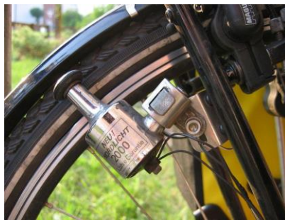
ΕΙΚΟΝΑ 6: Ένα ΔΥΝΑΜΟ ΤΟΠΟΘΕΤΗΜΕΝΟ ΠΑΝΩ Σ' ΕΝΑ ΠΟΔΗΛΑΤΟ. (ΕΙΚΟΝΑ: HTTPS://EN.WIKIPE-DIA.ORG/WIKI/BOTTLE_DYNAMO#/ME-DIA/FILE:FAHRRAD-DETAIL-23.JPG )
