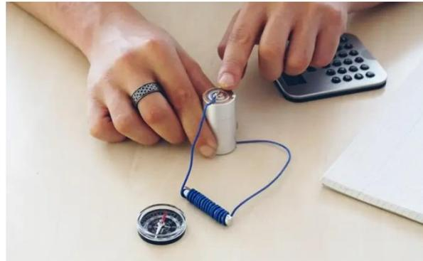
Quando o circuito está aberto, portanto sem corrente a fluir através do fio, a bússola indica o norte magnético da terra. Se fecharmos o circuito, deixando a corrente fluir, então a agulha da bússola aponta noutra direção para norte.
